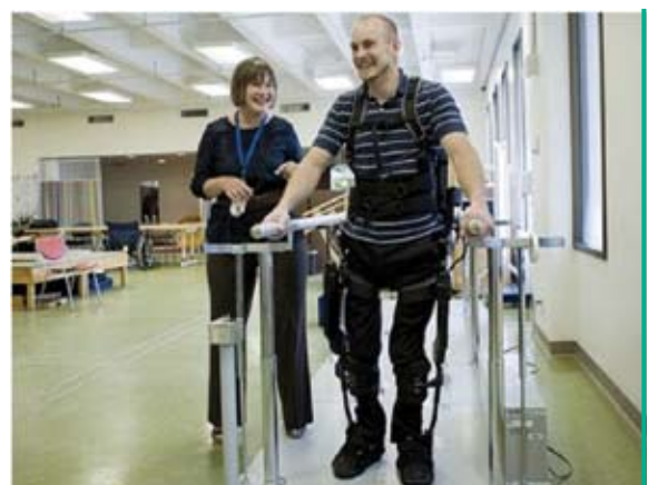
Abb. 9: HULC, ein Gehapparat für Paraplegiker.
